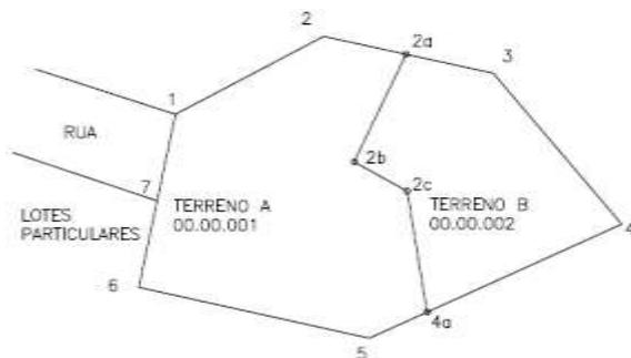
Os pontos da poligonal deverão ser representados por um triângulo, com sua numeração. Utilizar a projeção UTM para a determinação das coordenadas. O Referencial planimétrico (DATUM horizontal) a ser utilizado é o SAD-69 (South American Datum, 1969).
