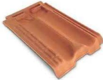
Possui encaixes transversal e longitudinal, bem como ranhuras na lateral da peça, para aumentar a segurança em caso de trânsito sobre ela. Possui outros rebaixos, à guisa de canais, para facilitar o escoamento da água.
