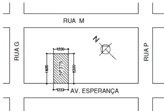
O Norte Magnético deverá ser inserido (norte\_magnetico.dwg) e rotacionado, conforme a necessidade, para indicar a direção do norte magnético, de forma que o prédio fique na posição horizontal/vertical em relação à folha, e a data do levantamento, no formato dd/mm/aa, deverá ser preenchida.
