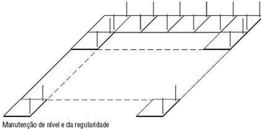
Nos forros com estrutura de sustentação, o encaixe das presilhas é feito nas ranhuras ou rebaixos, conforme o avanço da colocação. O espaçamento em cada borda não deve ultrapassar 60 cm.
