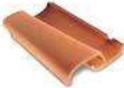
O escoamento ocorre pelo canal. A capa evita a penetração de água recobrindo, longitudinalmente, 2 canais vizinhos. O recobrimento transversal é de 6 cm, o que determina um espaçamento entre ripas (galga) de 40 cm, em média; variando entre fabricantes. A telha apresenta detalhes que propiciam bom encaixe entre canais e ripas e entre capas e canais.
